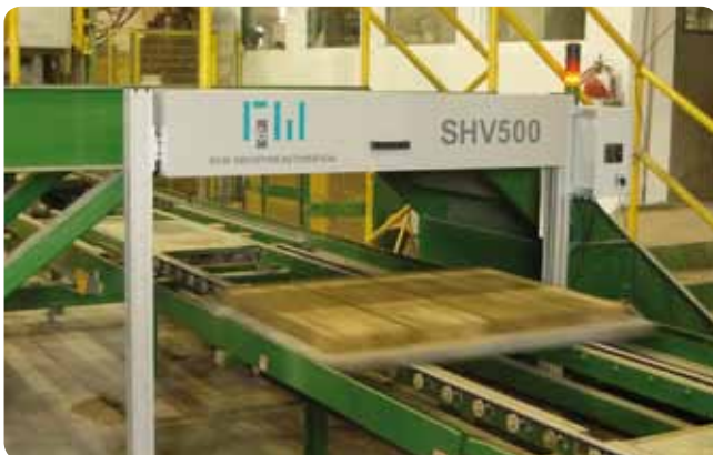
Obr. 1 Snímače kontinuálne zaznamenávajú výšku blokov.
