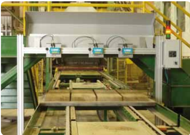
Obr. 3 Snímače merajú kolmo na dopravnú dosku s použitím laserovej triangulácie.
