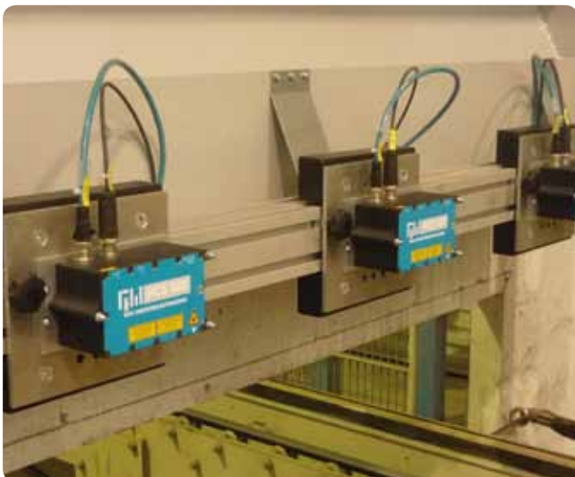
Obr. 4 Krytie snímača je oproti štandardnému modelu zväčšené.
